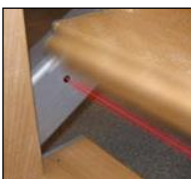
Des capteurs à infrarouge évitent tout risque d'écrasement entre les marches.
